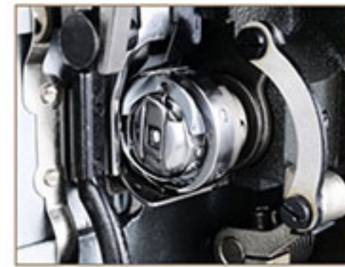
两倍旋梭（可选） Two times large hook(optional)
